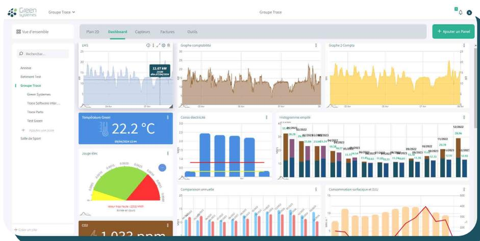
Connectée aux flux distributeurs, IoT et des GTB, la Green Solution permettra de stocker sur une durée indéterminée les données au pas de temps paramétré lors de la collecte de la donnée (jusqu'à 10 minutes). Les données sont ensuite restituées dans des tableaux de bord entièrement personnalisables à des fins d'analyse et préconisation.
